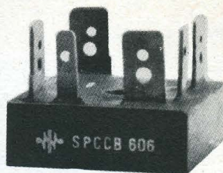
Realizzazione pratica di un ponte integrato utilizzando diodi SCR: progetto Dospa Olivetti.
